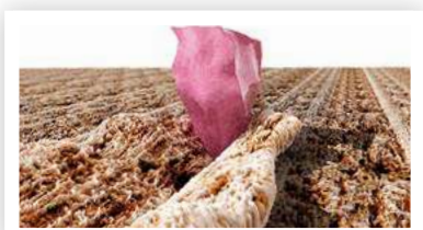
» Зерно оксида алюминия царапает древесину мягких пород.
