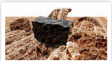
» Зерно карбида кремния режет древесину твердых пород.
