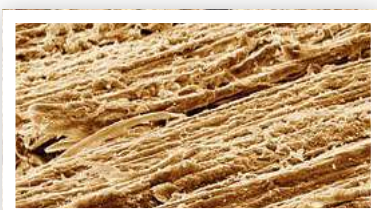
» Поверхность дерева после обработки зерном из оксида алюминия.
