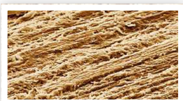
» Поверхность дерева после обработки зерном из карбида кремния.
