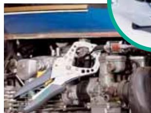
Варируемая сила зажима благодаря крепкой храповой механике
