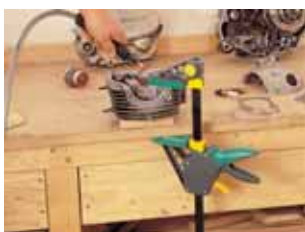
просто выполняемое переоборудование для функции распора
