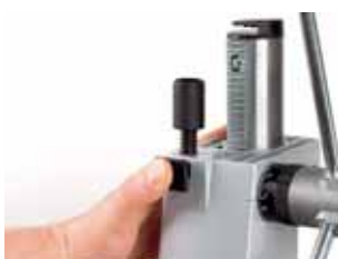
регулировка глубины при помощи упора ограничения глубины, приспособленного для быстрой регулировки
