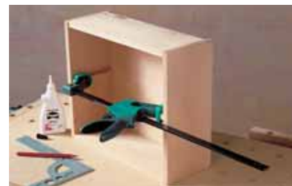
просто выполняемое переоборудование для функции распора
