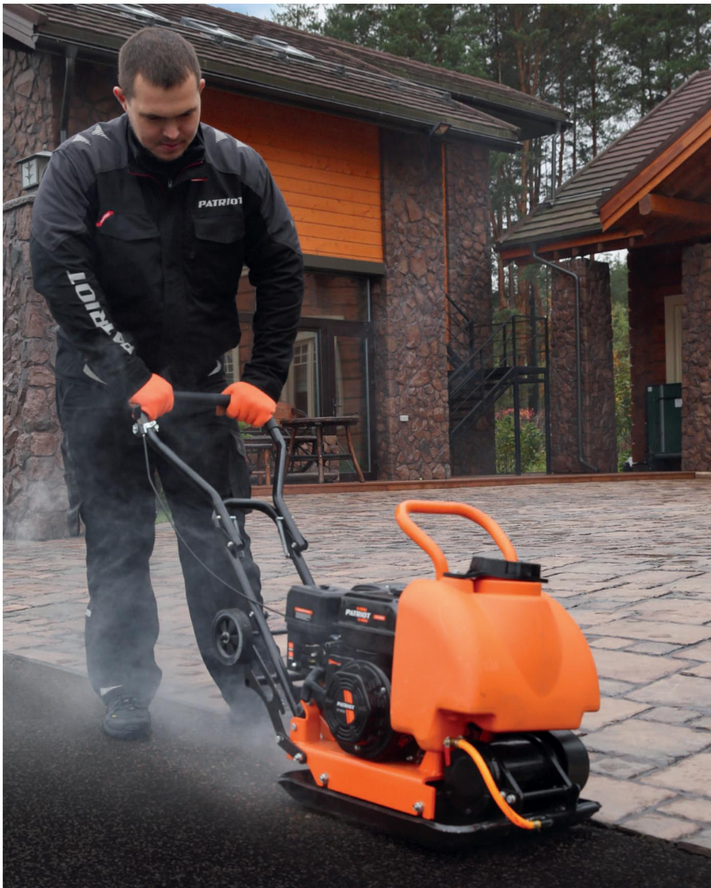
Бензиновые виброплиты прямого хода используются в качестве миниатюрного катка. Надежный четырехтактный двигатель и прочная стальная рама позволяют использовать виброплиту в самых тяжелых условиях. Сбалансированная частота и амплитуда вибратора, эргономичные рукоятки уменьшают нагрузку на руки оператора и облегчают условия работы. Бак для воды в стандартной комплектации. Используемый тип топлива - бензин АИ-92.
