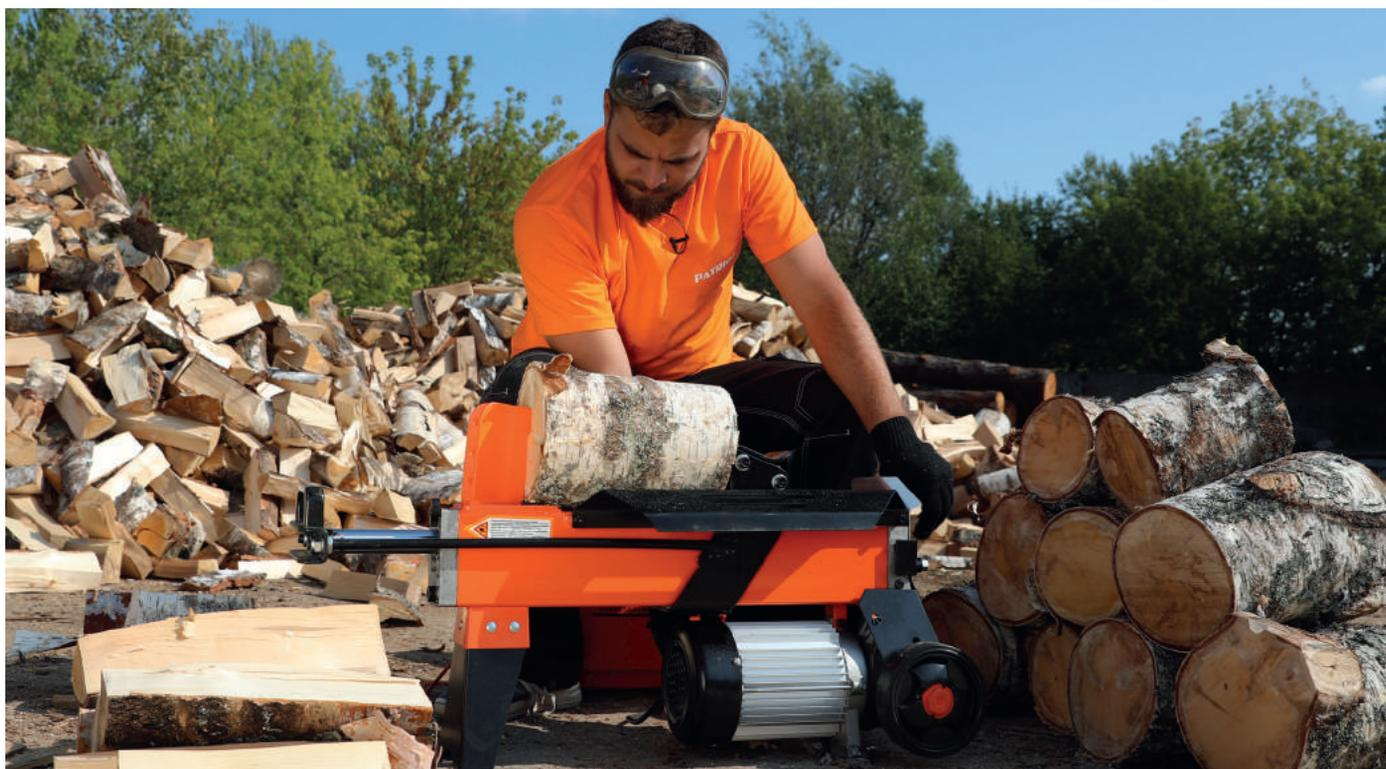
Электрические дровоколы - безопасные устройства для быстрой заготовки дров в больших объемах на приусадебных участках. Развивает усилие 4–5 тонн. Агрегат оснащен двигателем, работающим от сети 220 В. Электродвигатель позволяет использовать дровокол в закрытых помещениях. Для удобства транспортировки на небольшие расстояния имеются колеса.
