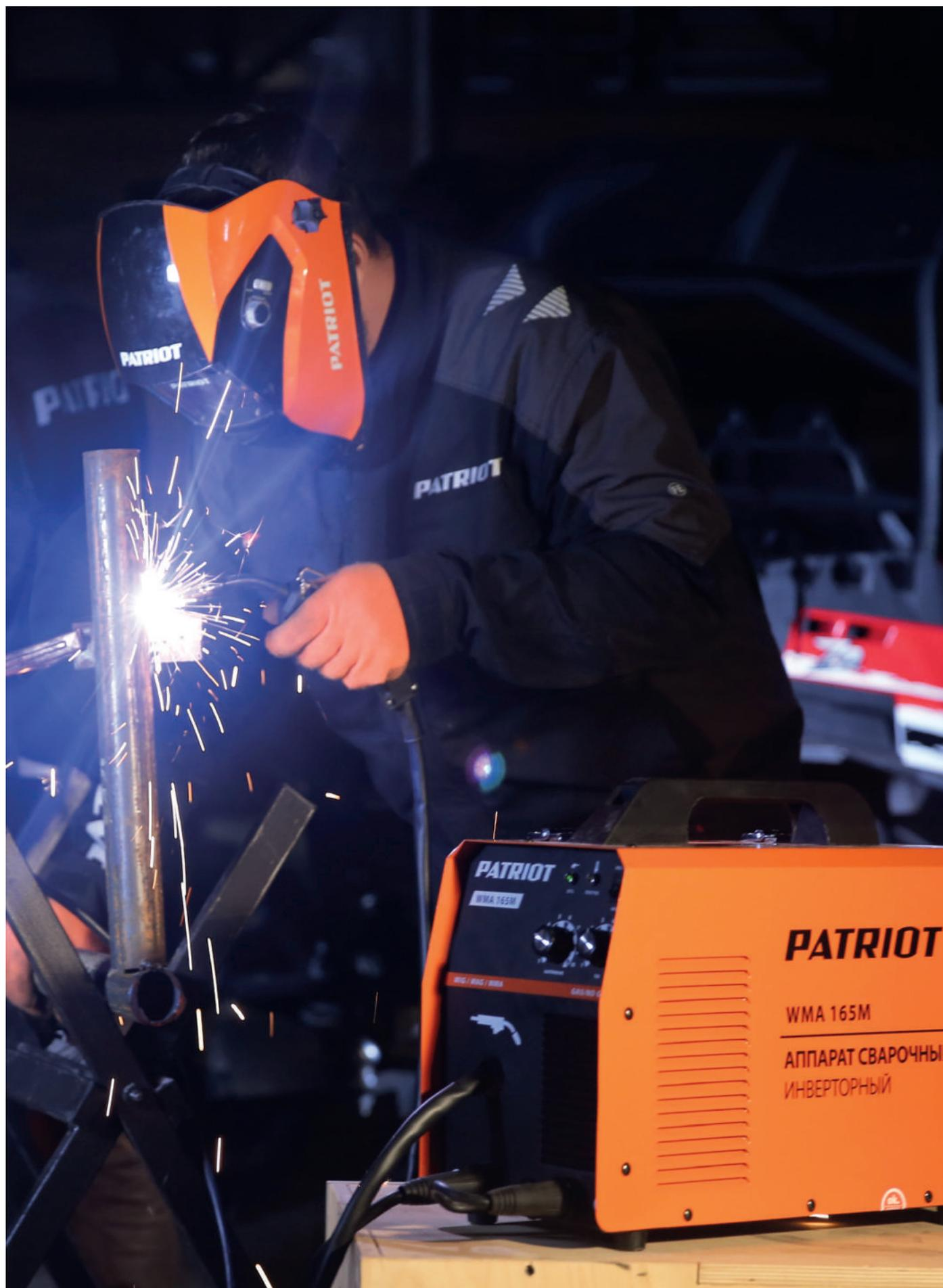
Сварочный аппарат предназначен для полуавтоматической сварки в среде газа (MIG/MAG) стальной проволокой, а также сварки флюсованной проволокой (Flux) диаметром 0,6, 0,8 мм.
