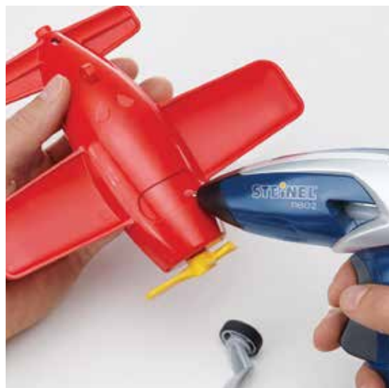
Ремонт пластиковой игрушки с помощью горячего клея
