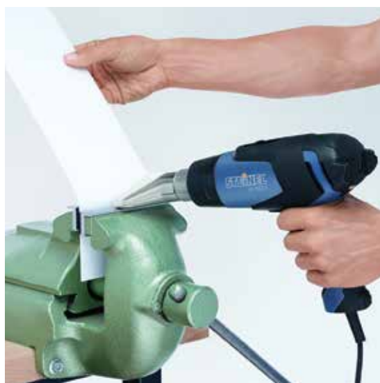
Придание желаемой формы пластику с помощью нагрева
