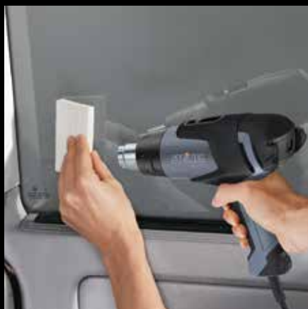
Нанесение защитной оконной пленки HG 2120 E
