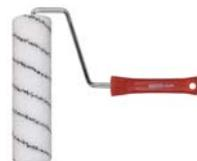
D 47/73 мм, высота ворса 13 мм. Бюгель 8 мм., съемный. Система трехточечного крепления ручки. Способ крепления шубки: термосинтез. Используется для красок на водной основе. Для гладких и полусухоховатых поверхностей. Материал: шубка из специального полиэстера, полипропиленовая основа.
