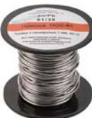
ГОСТ 21931-76. На катушке. Применяется для лужения и пайки электро- и радиоаппаратуры, печатных схем, точных приборов с высокогерметичными швами, где недопустим перегрев. Температура плавления: 183 - 190 °С.
