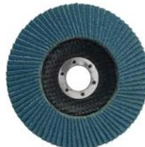
Тип 1 (Плоский). 80 лепестков. Для УШМ. Посадочный диаметр 22,2 мм. Для сухого шлифования и снятия краски с **нержавеющей стали**, инструментальной стали, чугуна, цветных металлов, пластика, дерева. Материал: абразивный слой - 100% цирконий, основа - х/б ткань, подложка - стекловолокно, обод - инструментальная сталь.
