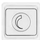
Диммер для скрытой проводки. Используется для плавной регулировки интенсивности освещения. Тип зажимов: винтовой. Напряжение в сети: 220-250 В. Частота тока: 50 Гц. Номинальный ток: 2,5 А. Сечение присоединяемых к контактам проводников от 0,1 до 2,5 мм<sup>2</sup>. Материалы: корпус из ударопрочного ABS пластика, детали контактных групп из латуни. Упаковка: пакет с подвесом.
