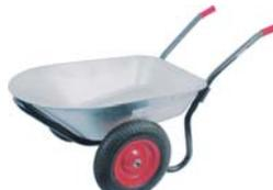
Двухколесная. Грузоподъемность 165 кг. Объем тачки 78 л. Диаметр надувного колеса 16" x 4". Вес тачки 13,9 кг. Кузов: стальной оцинкованный. Рама из стальных труб, окрашенная. Прорезиненные ручки.
