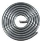
ГОСТ 21931-76. Применяется для лужения и пайки электро- и радиоаппаратуры, печатных схем, точных приборов с высокогерметичными швами, где недопустим перегрев. Температура плавления: 183 - 190 °С.
