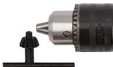
Трехулачковый. Для использования с ручными и электрическими дрелями. Надежная фиксация сверла. Посадочный диаметр 1/2". Т-образный ключ в комплекте. Материал: инструментальная сталь. Упаковка: картонная коробка.
