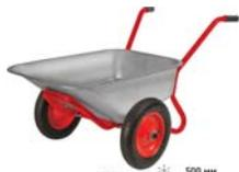
Двухколесная. Объем: 110 л. Грузоподъемность 260 кг. Рама из крашеной стальной трубы диаметром 32 мм. Тип колеса: полиуретановое. Диаметр колеса: 360 мм. Посадочный диаметр колеса 25,4 мм. Колеса, рама и крепеж упакованы в картонную коробку.
