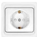
Розетка для скрытой проводки. Тип зажимов: винтовой. Напряжение в сети: 220-250 В. Частота тока: 50 Гц. Номинальный ток: 16 А. Сечение присоединяемых к контактам проводников от 0,1 до 2,5 мм<sup>2</sup>. Материалы: корпус из ударопрочного ABS пластика, детали контактных групп из латуни. Упаковка: пакет с подвесом.
