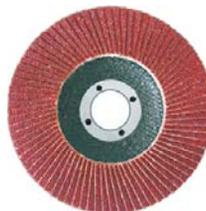
Тип 2 (Конический). Для УШМ. Шлифовальный. 72 лепестка. Лепестки расположены под углом. Посадочный диаметр 22,2 мм. Материал: х/б ткань, стекловолокно, абразивный слой из оксида алюминия.
