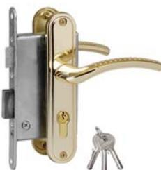
Замок врезной с ручками, цилиндрический. Предназначен для установки в деревянные двери толщиной 40 - 50 мм, правого и левого открывания. Стальной оцинкованный корпус. Прямоугольный ригель из цинкового сплава, вылет 22 мм. Межосевое расстояние 55 мм. Удаление ключевого отверстия 55 мм. Габаритный размер 85 x 130 мм. Материал ручек: алюминиевый сплав, гальваническое покрытие. В комплекте: ответная планка, стяжки, цилиндр 60 мм, 3 ключа. Упаковка: картонная коробка.
