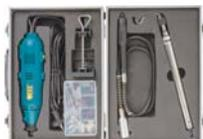
135 Вт; 10000-32000 об/мин; 2,4/3,2 мм; 0,7 А; 1,2 кг; алюминиевый кейс. Электронная регулировка оборотов, надежный клавишный переключатель, быстрый доступ к щеткам, блокировка шпинделя, телескопический штатив, гибкий вал, комплект аксессуаров.
