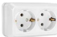
Розетка для внешней проводки. Напряжение в сети: 220-250 В. Частота тока: 50 Гц. Номинальный ток: 16 А. Сечение присоединяемых к контактам проводников: от 0,1 до 2,5 мм<sup>2</sup>. Материалы: корпус из ударопрочного ABS пластика, детали контактных групп из латуни. Упаковка: пакет с подвесом.
