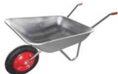
Грузоподъемность 100 кг. Объем 65 л. Диаметр надувного колеса 13" x 3". Вес 8,6 кг. Кузов: стальной, оцинкованный. Рама: гнuto-сварная, трубчатая оцинкованная. Колесо на шарикоподшипнике. Прорезиненные ручки. Может использоваться с колесом FIT 77565.
