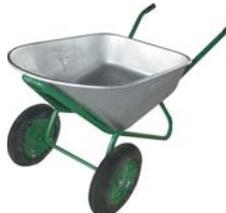
Профи. Двухколесная. Грузоподъемность 250 кг. Объем 100 л. Диаметр надувного колеса 16" x 4". Вес 17 кг. Кузов: стальной оцинкованный. Рама из стальных труб, окрашенная. Прорезиненные ручки.
