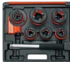
Набор для нарезания наружной резьбы на металлических трубах стандартного диаметра. Материал: инструментальная сталь с черным покрытием, корпус из высококачественного чугуна, резы из легированной стали. Упаковка: пластиковый чемодан.
