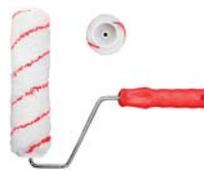
40/62 мм. Бюгель 6 мм. Ворс 11 мм. Для гладкой и полуглянцевой поверхности. Стержневая система. Пластиковая основа. Используется со всеми видами красок. Шубка крепится к основе по технологии термодиффузии.
