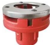
Для нарезания наружной резьбы на металлических трубах стандартного диаметра. Материал: инструментальная сталь с хромированным покрытием, корпус из высококачественного чугуна, резы из легированной стали. Упаковка: картонная коробка.
