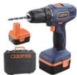
Дрель-шуруповерт аккумуляторная. 12 В; двухскоростной планетарный редуктор 0-350/0-1100 об/мин; быстросъемный патрон 10 мм; максимальный крутящий момент 25 Нм; 2 батареи (Ni-Cd) x 1,5 Ач; быстрая зарядка батареи 1 ч.; регулировка частоты вращения; регулировка крутящего момента 15+1; реверс; резиновые вставки; LED подсветка; 1,5 кг; кейс.
