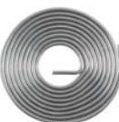
ГОСТ 21931-76. Применяется для лужения и пайки электро- и радиоаппаратуры, печатных схем, точных приборов с высокогерметичными швами, где недопустим перегрев. Температура плавления: 183 - 190 °С.
