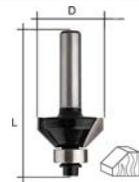
Используется для работ по дереву. С нижним подшипником. Для фрезерования кромок. Угол при вершине 90°. Цилиндрический хвостовик 8 мм. Материал: инструментальная сталь с твердосплавными режущими вставками. Упаковка: двойной блистер.
