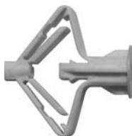
Материал – полипропилен. Предназначен для крепления к гипсокартону, ГВЛ, ДСП и другим материалам (толщиной 10-12 мм). Может применяться и в случае использования двойного слоя гипсокартона или ГВЛ общей толщиной 20-24 мм.
