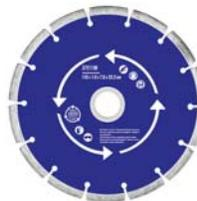
Сегментный. Для использования с УШМ. Посадочный диаметр 22,2 мм. Для "сухой" и "влажной" резки кирпича, бетона, мрамора, гранита и других твердых материалов. Сегментная режущая кромка обеспечивает охлаждение диска в процессе работы, предотвращая его перегрев. Материал: инструментальная сталь, режущая кромка - расправ с техническими алмазами. Упаковка: блистер.
