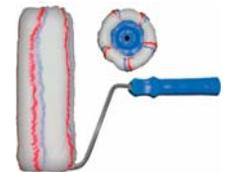
D 48/84 мм, ворс 18 мм. Бюгель 8 мм. Система с пластиковым роликом. Для полуглянцевой и грубой поверхности. Используется с вододисперсионными и масляными красками.
