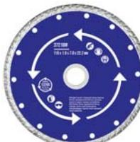
«Турбо». Для использования с УШМ. Посадочный диаметр 22,2 мм. Для «сухой» и «влажной» резки кирпича, бетона, армированного бетона, мрамора, гранита и других твердых материалов. Специальный профиль режущей кромки «Турбо» увеличивает скорость реза и способствует более эффективному удалению обработанного материала, предотвращая перегрев диска. Материал: инструментальная сталь, режущая кромка - расправ с техническими алмазами. Упаковка: блистер.
