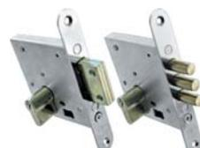
Цилиндрический, без ручек, латунный цилиндр 60 мм. Левые и правые двери 40-50 мм. Прямоугольный или 3-х стержневой ригель. Ответная планка. Материал: инструментальная сталь, латунный цилиндр. Упаковка: картонная коробка.
