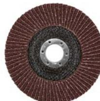
Тип 2 (Конический). Для обработки различных материалов. Используется с УШМ. 80 лепестков. Лепестки расположены под углом. Посадочный диаметр 22,2 мм. Материал: полимерная основа, абразивный слой - оксид алюминия.
