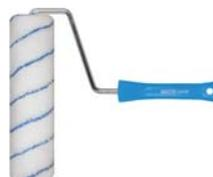
D 48/66 мм, высота ворса 9 мм. Бюгель 8 мм., съемный. Система трехточечного крепления ручки, для бюгеля 8 мм. Используется для лаков на водной основе. Для гладких поверхностей. Материал: шубка из полиакрила, полипропиленовая основа. Способ крепления шубки: термосинтез.
