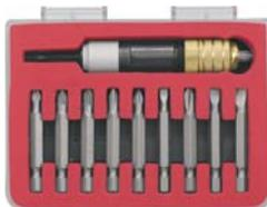
В наборе: магнитный адаптер для бит длиной 50 мм для закручивания шурупов на заданную глубину при производстве гипрочных работ, сборке упаковки; 9 бит (L=50 мм): SL4, SL5, SL6, PH1, PH2, PH3, PZ1, PZ2, PZ3. Материал: биты и механизм расщепления – сталь S2, ограничитель глубины из алюминия, держатель из инструментальной стали, хвостовик из хром-ванадиевой стали. Упаковка: пластиковая коробка в блистере.
