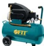
1500 Вт; 2,0 л.с.; 200 л/мин; 8,0 бар; 50 л; 2800 об/мин; 7,5 А; 34 кг; коробка. Поршневой одноцилиндровый, прямой привод компрессора, маслонаполненный картер, автоподдержка давления, два контрольных манометра, реле токовой защиты двигателя, предохранительный клапан давления, транспортировочные колеса и ручка, принудительное воздушное охлаждение, термореле защиты двигателя от перегрева.
