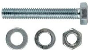
Комплект метрического крепежа состоит из: болт DIN933 (класс прочности 5.8), гайка шестигранная DIN934, шайба DIN125, шайба гроверная DIN127. Рекомендуются для крепления и соединения узлов и деталей в машиностроении, строительстве. Материал: конструкционная оцинкованная сталь.
