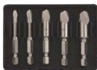
Для выкручивания шпилек и болтов с поврежденным шлицем, с классом прочности не выше 10.9, диаметром от 7 до 18 мм. Для профессионального использования. U-образный хвостовик под биты. Материал: HSS сталь P9M3 повышенной твердости. Упаковка: блистер.
