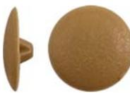
Применяется для декорирования шляпок шурупов и саморезов. На шлиц PH2 (крест). Материал: полипропилен, тонированный в базовые цвета.
