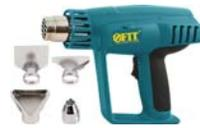
2000 Вт; 250/550 °С; поток воздуха 250/550 л/мин; установочный диаметр насадок 34 мм; 8,7 А; 0,73 кг; коробка. 4 сменные насадки, 2 температурных режима, клавишный переключатель, термореле для защиты от перегрева, возможность стационарной установки.
