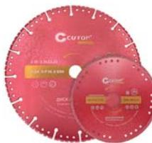
Высокая плотность расположения алмазов в режущем слое позволяет использовать диск для резки металлического профиля, арматуры, бетона, кирпича, гранита, мрамора. Посадочный диаметр 22,2 мм. Материал: высокоуглеродистая термообработанная инструментальная сталь, режущая кромка содержит порошок из технических алмазов. Упаковка: двойной блистер.
