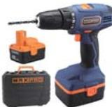
Дрель-шуруповерт аккумуляторная. 18 В; двухскоростной планетарный редуктор 0-350/0-1100 об/мин; быстросъемный патрон 10 мм; максимальный крутящий момент 29 Нм; 2 батареи (Ni-Cd) x 1,5 Ач; быстрая зарядка батареи 1 ч.; регулировка частоты вращения; регулировка крутящего момента 15+1; реверс; резиновые вставки; LED подсветка; 1,8 кг; кейс.
