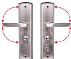
Подходят для замков автоматического и не автоматического закрывания. Межосевое расстояние - 68 мм, размеры планки - 60 x 275 мм, длина / высота ручки - 120 / 45 мм соответственно. Цвет ручек и планки - никель / хром. В комплекте: 2 ручки, винтовые стяжки, пластиковые прокладки под ручки, квадрат (8 x 8 мм) 110 мм, комплекты стержней для автоматических и не автоматических замков. Материал: сталь 1,1 мм, гальваническое покрытие. Упаковка: картонная коробка.
