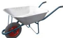
Грузоподъемность 140 кг. Объем 65 л. Диаметр надувного колеса 13" x 3". Вес 9,6 кг. Кузов: стальной оцинкованный. Рама из стальных труб, окрашенная. Прорезиненные ручки.
