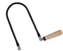
Для работ по дереву. Материал: инструментальная сталь, деревянная ручка.
