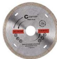
Профессиональный отрезной алмазный диск для промышленного использования. Для влажной резки кафеля. Толщина диска 1,2 мм. Посадочный диаметр 22,2 мм. Предназначен для углошлифовальных и отрезных машин. Повышенная износоустойчивость. Материал: высококачественная инструментальная сталь, режущая кромка содержит порошок из технических алмазов. Упаковка: двойной блистер.
