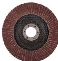
Тип 1 (Плоский). 125 x 22,2 мм. Для обработки различных материалов. Используется с УШМ. 80 лепестков. Материал: полимерная основа, абразивный слой - оксид алюминия.
