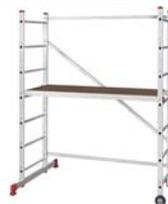
Рабочая площадка может устанавливаться на разных уровнях. Размеры рабочей площадки 138 x 50 см. Максимальная рабочая высота 304 см. Нагрузка допустимая 150 кг. Габаритные размеры в сложенном состоянии 185 x 55 x 14 см. Вес 14,7 кг. Материал: алюминий.
