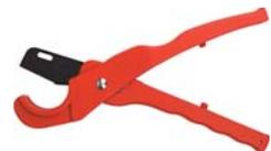
Для резки трубок из пластика и металлопластика. Специальная форма лезвия для предотвращения заминания краев трубок. Материал: корпус из алюминиевого сплава с порошковым покрытием, лезвие из высокоуглеродистой стали SK-5 с тефлоновым покрытием. Упаковка: блистер.
