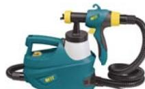
500 Вт; 320 мл/мин; 50 din/сек; 1,8 мм; 700 мл; 1,7 А; 2,2 кг; коробка. Переносной нагнетатель, облегченный распылитель, брызгозащитный выключатель, специальный плечевой ремень, регулировка формы факела, регулировка расхода материала, компрессор турбинного типа, съемный узел распыления, широкий выбор материалов.
