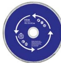
Сплошной. Для использования с УШМ. Посадочный диаметр 22,2 мм. Для "влажной" резки кафельной плитки (с подачей охлаждающей жидкости). Сплошная режущая кромка обеспечивает точный и ровный рез. Материал: инструментальная сталь, режущая кромка - расправ с техническими алмазами. Упаковка: блистер.
