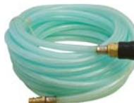
Прямой. Усиленный, армированный полимерными нитями. Шланг-удлинитель с коннекторами европейского типа. Соединение быстросъемное 1/4". Диаметр внутренний - 6 мм, диаметр внешний - 11 мм. Рабочее давление - 6 бар, максимальное давление - 20 бар. Диапазон рабочих температур от -5 до +65 °С. Материал: армированный ПВХ.
