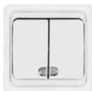
Выключатель для скрытой проводки. Тип зажимов: винтовой. Напряжение в сети: 220-250 В. Частота тока: 50 Гц. Номинальный ток: 10 А. Сечение присоединяемых к контактам проводников от 0,1 до 2,5 мм<sup>2</sup>. Материалы: корпус из ударопрочного ABS пластика, детали контактных групп из латуни. Упаковка: пакет с подвесом.
