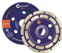
2 ряда сегментов. Посадочный диаметр 22,2 мм. Для работы по камню, кирпичу, бетону и аналогичным строительным материалам. Материал: высокоуглеродистая сталь, режущая кромка содержит технические алмазы. Упаковка: блистер.
