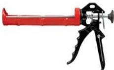
Профи. Полуоткрытый. Для выдавливания герметика из стандартной емкости 310 мл. Шток круглый. Материал: инструментальная сталь, алюминий.
