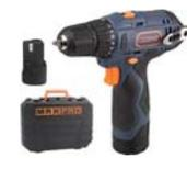
Дрель-шуруповерт аккумуляторная. 12 В; двухскоростной планетарный редуктор 0-350/0-1300 об/мин; быстросъемный патрон 10 мм; максимальный крутящий момент 26 Нм. 2 батареи (Li-Ion) x 1,3 Ач; регулировка крутящего момента 17+1; быстрая зарядка батареи 1 ч.; регулировка частоты вращения; реверс; резиновые вставки; LED подсветка; 1 кг; кейс.
