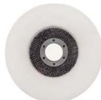
Для финишной полировки различных поверхностей. Используется с полировальной машиной или УШМ. Посадочный диаметр 22,2 мм. Материал: полировальный слой - войлок, подложка - фиброглас, обод - инструментальная сталь. Упаковка: П/Э пакет с картонным подвесом.
