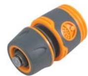
С клапаном "автостоп". Применяется для быстрого и надежного соединения поливочных шлангов с любой насадкой поливочной системы. Совместим со всеми элементами аналогичной поливочной системы. Клапан "автостоп" автоматически прекращает подачу воды при отсоединении насадки. Материал: ABS пластик с прорезиненными вставками. Упаковка: блистер.
