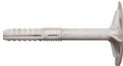
Дюбель для теплоизоляции IZO - полипропиленовый распорный дюбель для крепления в бетон, кирпич плит из минеральной ваты и пенопласта с пластмассовым гвоздем.
