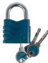
Материал: алюминиевый корпус, латунный механизм секрета, дужка и ключ из инструментальной стали. Механизм секрета - дисковый, с защитой от высверливания. Тип ключа: финский. Закаленная дужка. Количество ключей: 3. Упаковка: блистер.
