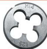
Для нарезания внешней резьбы на изделиях из стали и цветных металлов. Направление резьбы правое. Закалка до HRC 58-60. Материал: легированная сталь.
