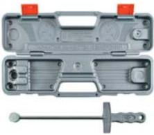
КМШ-140. Шкальный. С посадочным гнездом на вороток. Для нормированной затяжки резьбовых соединений с контролируемым крутящим моментом. Цена деления 5 Нм. Материал стержня и головки: конструкционная легированная сталь.
