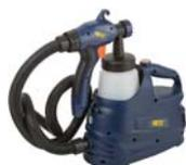
650 Вт; 400 мл/мин; 80 din/сек; 2 мм; 800 мл; 2,9 А; 2,2 кг; коробка. Технология распыления HVLP обеспечивает высокую эффективность переноса материала на окрашиваемую поверхность. Переносной нагнетатель, облегченный распылитель, брызгозащитный выключатель, специальный плечевой ремень, регулировка формы факела, регулировка расхода материала, компрессор турбинного типа, мощный коллекторный двигатель, система фильтрации воздуха, широкий выбор применяемых материалов.
