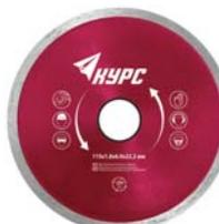
Сплошной. Для влажной резки кафеля. 37251/37252 посадочный диаметр 22,2 мм, 37256 посадочный диаметр 25,4 мм. Материал: инструментальная сталь, режущая кромка содержит порошок из технических алмазов. Упаковка: картонный конверт.
