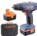
Дрель-шуруповерт аккумуляторная. 12 В; двухскоростной планетарный редуктор 0-350/0-1100 об/мин; быстросъемный патрон 10 мм; максимальный крутящий момент 27 Нм; 2 батареи (Ni-Cd) x 1,5 Ач; быстрая зарядка батареи 1 ч.; регулировка частоты вращения; регулировка крутящего момента 15+1; реверс; резиновые вставки; LED подсветка; 1,5 кг; кейс.
