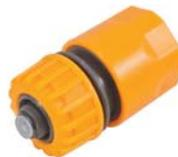
С клапаном "автостоп". Применяется для быстрого и надежного соединения поливочных шлангов с любой насадкой поливочной системы. Совместим со всеми элементами аналогичной поливочной системы. Клапан "автостоп" автоматически прекращает подачу воды при отсоединении насадки. Материал: ABS пластик. Упаковка: блистер.
