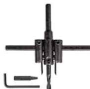
«Балеринка». Для высверливания отверстий в дереве, гипсокартоне, пластике. С регулируемым диаметром. Материал: центральное сверло из инструментальной стали, резы из легированной стали.
