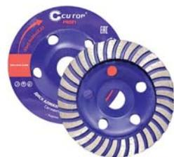
Для работы по бетону, камню, кирпичу. Высокая производительность и идеальная балансировка, что способствует качественной работе. Сегментированная кромка «ТУРБО» усиливает воздушное охлаждение и отвод отработанного материала, предотвращая перегрев диска. Материал: инструментальная сталь, режущая кромка содержит порошок из технических алмазов. Упаковка: блистер.
