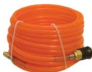
Прямой. Шланг-удлинитель с коннекторами европейского типа. Соединение быстросъемное 1/4". Диаметр внутренний - 5 мм, диаметр внешний - 8 мм. Рабочее давление - 6 бар, максимальное давление - 20 бар. Диапазон рабочих температур от -15 до +45 °С. Материал: полиуретан.
