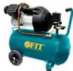
2200 Вт; 3,0 л.с.; 356 л/мин; 8,0 бар; 50 л; 2800 об/мин; 11,0 А; 42 кг; коробка. Поршневой двухцилиндровый, прямой привод компрессора, маслонаполненный картер, автоподдержка давления, два контрольных манометра, реле токовой защиты двигателя, предохранительный клапан давления, транспортировочные колеса и ручка, принудительное воздушное охлаждение, термореле защиты двигателя от перегрева.
