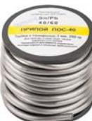
ГОСТ 21931-76. На катушке. Для лужения и пайки меди, латуни, оцинкованного железа. Применяется для ремонта радиаторов, монтажа медных и латунных трубопроводов, ремонта электроаппаратуры. Температура плавления 183 - 238 °С.
