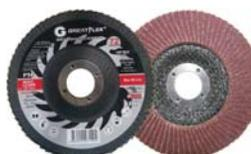
Круг класса «МАСТЕР» для повседневного использования. При изготовлении используется гибкий абразивный материал состоящий из тканевой основы, на которую нанесен оксид алюминия - Корунд. Произведено с использованием технологий и контролем качества CUTOP. Наполняемость диска составляет 72 лепестка с углом наклона 10 градусов, что позволяет увеличить площадь контакта обрабатываемой поверхности и КПД круга. Предназначен для обработки металла. Для углошлифовальных машин. Посадочный диаметр 22,2 мм.
