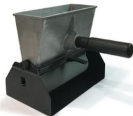
Клеенаносящие инструменты имеют литой алюминиевый контейнер и модульную конструкцию, которая позволяет легко разобрать, очистить и так же легко собрать инструмент. Подставка позволяет вертикально держать инструмент в промежутках между работой. Клеенамазка поставляется с валиком и металлической подставкой. Все запасные части можно заказать отдельно. Прорезиненный валик в комплекте.
