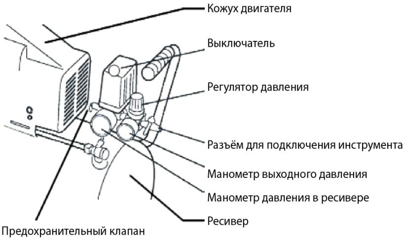
поршня вверх, воздух сжимается и подается в ресивер для накопления. По мере наполнения ресивера сжатым воздухом, давление в ресивере растет. При достижении максимально допустимого давления, автоматика отключит двигатель компрессора. При расходе сжатого воздуха из ресивера (например, для пневмоинструмента), давление в ресивере начинает падать. При достижении нижней уста новленной границы, автоматика включит двигатель для восполнения использованного воздуха.
