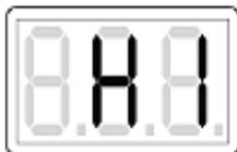
При напряжении сети более 260В, так же может сработать защита, аппарат отключится и на дисплее появится мигающая надпись HI. Нормальная работа аппарата не гарантирована.
