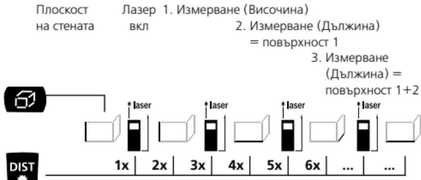
Добавяне на допълнителни повърхности: Лазер вкл / ...
