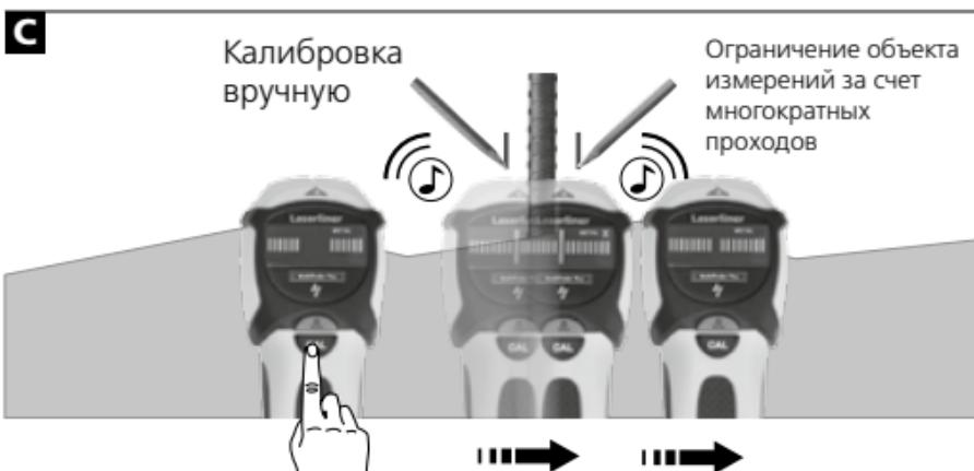
Указание 1: позиция между точками – средняя точка металлического объекта. Из-за высокой чувствительности измерения металлические объекты кажутся толще, чем на самом деле. Поэтому необходимо заново провести прибор над найденным объектом измерений, см. рис. В. При этом калибровка производится автоматически. Ручная калибровка должна выполняться вблизи обнаруженного в последний раз места, см. рис. С. При необходимости повторить этот порядок действий.
