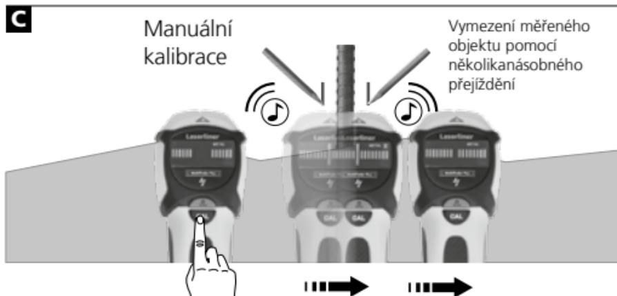
Tip 1: Mezi oběma značkami je střed kovového objektu. Díky vysoké citlivosti měření se silné kovové objekty jeví širší než ve skutečnosti. Proto přístrojem znova pohybujte přes nalezený měřený objekt, viz obrázek B. Přístroj se přitom kalibruje automaticky. Manuální kalibrace by se měla provést v blízkosti naposledy nalezeného místa, viz obrázek C. V případě potřeby tento postup opakujte.
