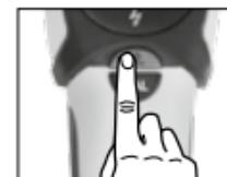
**AC-SCAN:** Обнаружение местонахождения проводов под напряжением прямо под неметаллическими отделочными материалами.
