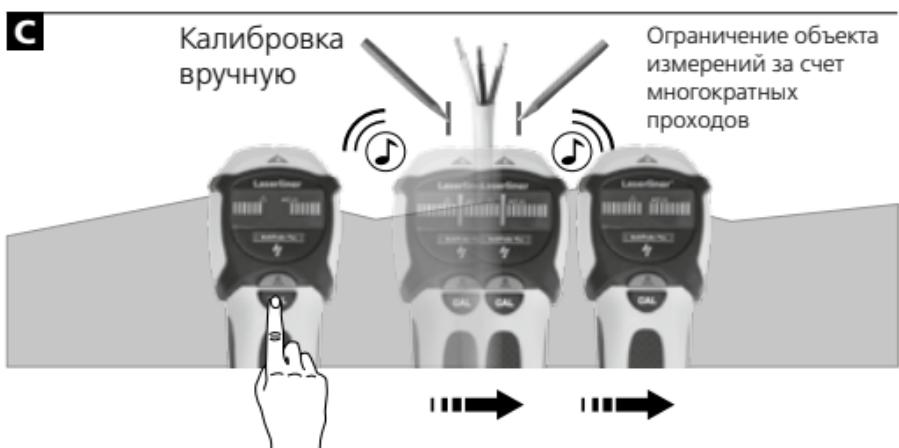
Указание 1: Ручная калибровка должна выполняться вблизи обнаруженного в последний раз места, см. рис. В/С. При необходимости повторить этот порядок действий.
