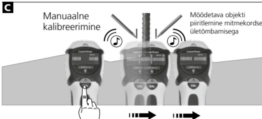
Vihje 1: Metallist objekti keskoht paikneb kahe märgistuse vahel. Kõrge mõõtetundlikkuse tõttu tunduvad jämedad metallobjektid laiemad kui tegelikkuses. Seetõttu liigutage seade uuesti üle leitud mõõdetava objekti, vt joonist B. Seade kalibreeritakse seejuures automaatselt. Manuaalset kalibreerimist tuleks teostada viimati leitud koha lächedal, vt joonist C. Korrale vajadusel toimimisviisi.
