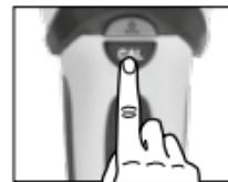
Maximální citlivosti přístroje se docílí, když se přístroj při kalibraci drží ve vzduchu. Může to být místy účelné u měření METAL- a AC-SCAN.
