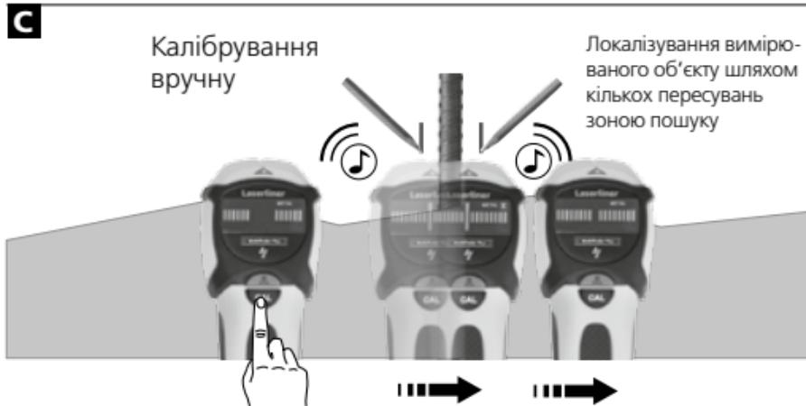
Вказівка 1: позиція між точками – середня точка металевого об'єкту. Через високу чутливість вимірювань металеві об'єкти здаються товщими, ніж є насправді. Тому прилад знову рухають над знайденим вимірюванням об'єктом (див. малюнок В). При цьому прилад автоматично калібрується. Калібрування вручну слід здійснити поблизу від останнього знайденого місця (див. малюнок С). Повторити цю процедуру за необхідністю.
