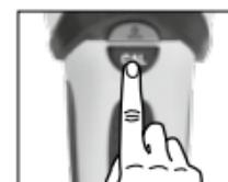
Максимальная чувствительность прибора достигается в том случае, когда прибор во время калибровки удерживается в воздухе. Это может быть целесообразно в отдельных случаях при измерениях в режимах METAL и AC-SCAN.
