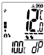
Небольшая опасность образования конденсата мигает значок „dP”
