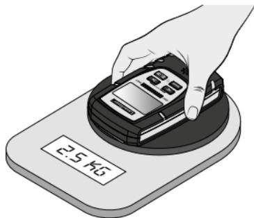
Повністю прикласти сенсорні накладки до вимірюваної поверхні і притиснути пристрій до вимірювальної поверхні з зусиллям натискання близько 2,5 кг.
