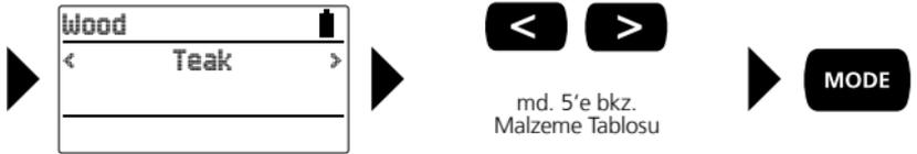
Malzeme seçimi yapıldıktan sonra, göstergenin üst kısmında seçilen ölçüm modu, alt kısmında ise seçilen malzeme gösterilir. % halinde ölçülen malzeme neminin güncel değeri, göstergenin ortasında okunabilir.
