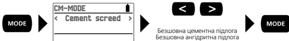
Режим СМ визначає рівень вологи матеріалу у порівнянні з методом вимірювання, який ґрунтується на реакції карбиду кальцію. Останній працює за принципом хімічної реакції, при цьому зразки будівельних матеріалів перевіряються на рівень вологості під високим тиском. В режимі СМ, в якому використовується метод неруйнівного електронного вимірювання, MoistureMasterCompact Plus відображає контрольну величину в СМ%.
