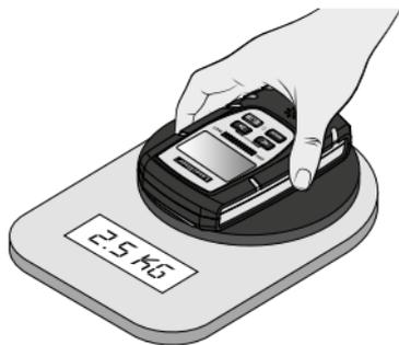
Уложить подложки реобразователей целиком на анализируемый материал и прижать прибор к исследуемой поверхности с усилием примерно 2,5 кг.
