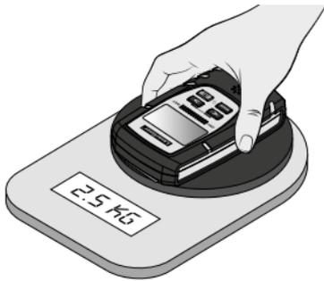
Sensör pedleri komple ölçüm malzemesinin üzerine yerleştirin ve cihazı yakl. 2,5 kg baskı ile ölçüm alanına bastırın.
