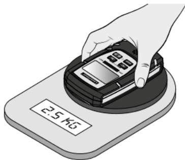
Vodivé kontakty úplně položte na měřený materiál a přístroj tlakem cca 2,5 kg zatlačte na měřenou plochu.
