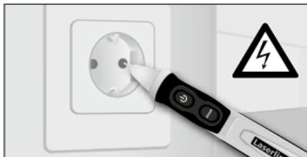
Če je napetost prisotna, konica detektorja zasveti rdeče in oglasi se hiter signal.
