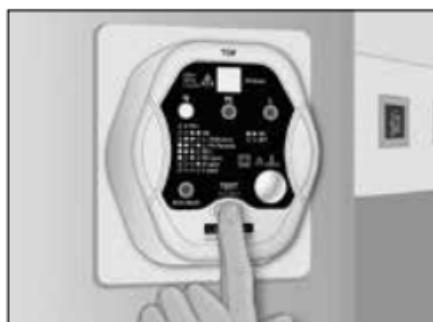
3. Stisknutím tlačítka „TEST“ (na 3 s) se aktivuje předřazený ochranný spínač FI/RCD.
