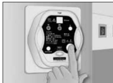
2. Прикоснуться пальцем к контактному электроду (5) и снять и проанализировать показания по следующей таблице.
