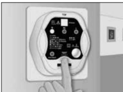
3. FI/RCD-vernebryteren utløses når du trykker på „TEST“-tasten (3 sekunder).
