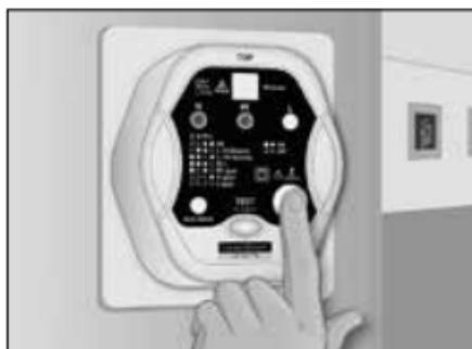
1. Sett apparatet inn i stikkontakten. Påse at TOP-markeringen er øverst.
