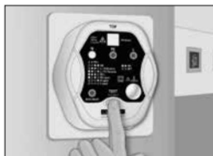
3. Після натискання кнопки "TEST" (3 с) спрацьовує аварійний вимикач пристрою захисного відключення (FI/RCD).
