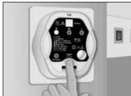
3. Genom att trycka på knappen „TEST“ (3 sek.) utlöses den förinställda FI/RCD-skyddsbrytaren.
