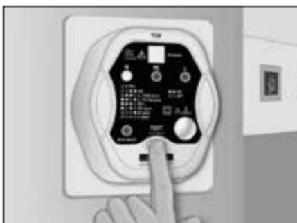
3. В результате нажатия кнопки „TEST“ (3 сек.) срабатывает предвключенный автомат FI/RCD.
