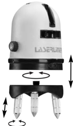
**Orientation de l'appareil:** La partie supérieure de l'appareil se tourne sur le socle pour permettre une orientation approximative du laser. Le positionnement exact peut être déterminé avec la roulette de réglage (4). Les pieds réglables (6) permettent de placer l'appareil sur des surfaces en pente.
