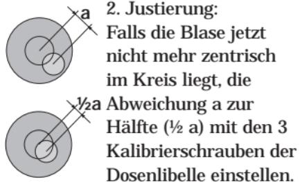
Hierbei je 2 Kalibrierschrauben leicht lösen, dann einstellen und wieder leicht anziehen. Danach die Dosenlibelle wieder mit den Nivellierschrauben einstellen und die Kalibrierung durch Drehen des Nivellierinstruments um  $180^\circ/200$  gon überprüfen.
