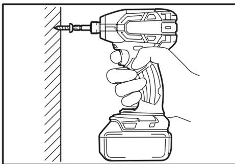
Соответствующий крутящий момент затяжки может отличаться в зависимости от типа или размера винта/болта, материала закрепляемой рабочей детали и т.д. Соотношение между крутящим моментом затяжки и временем затяжки показано на рисунках.
