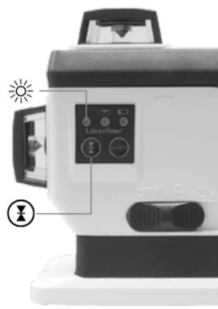
! Aufgrund der speziellen Optik zur Erzeugung einer durchgehenden 360° Laserlinie kann es zu Helligkeitsunterschieden in verschiedenen Bereichen der Linie, kommen, die technisch bedingt sind. Dies kann zu unterschiedlichen Reichweiten im Handempfängermodus führen.
