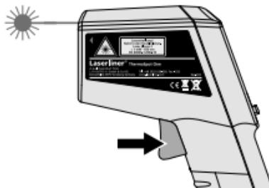
Μόλις αναγνωριστεί η επιθυμητή περιοχή μέτρησης με το στόχαστρο λέιζερ, αφήστε το πλήκτρο. Η μετρηθείσα τιμή διατηρείται.
