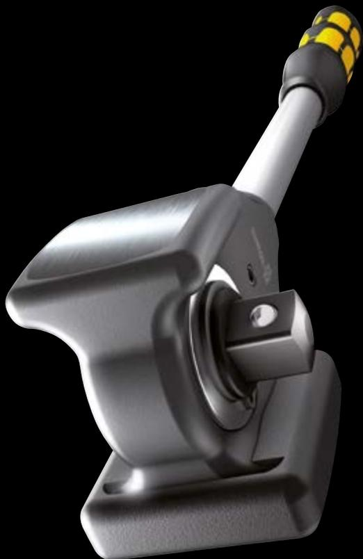
Двойное зацепление. Благодаря двойному храповому механизму 30 прочных зубцов действуют как тонкий механизм из 60 мелких зубцов с углом возврата всего 6°
