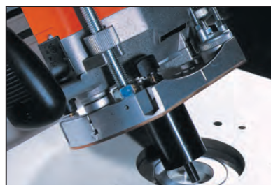
999.502.34 центрирующая втулка для правильной установки фрезера на пластину (8-12 мм / 5/16" - 15/32").
