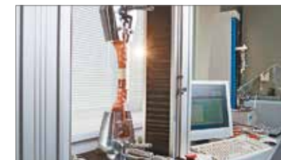
Испытания наконечников на разрывное усилие
