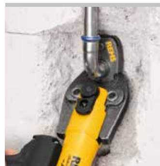
REMS пресс-клещи 45° (PR-2B) Патент EP 2 774 725
