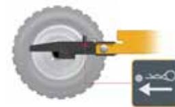
Закрепить замок с помощью шплинта
