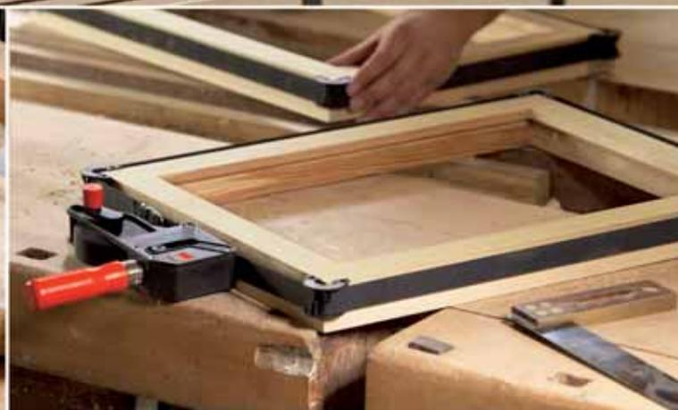
**Двусторонний равномерный зажим без перекоса**
