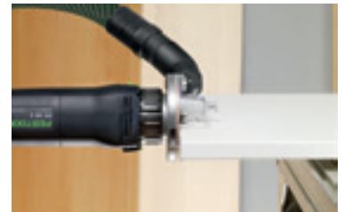
Скругление пластмассовой или деревянной кромки.
