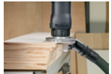
Фрезерование пластмассовой или деревянной кромки.
