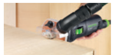
Фрезерование пластмассовой или деревянной кромки заподлицо.
