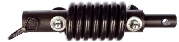
Предназначен для защиты от повреждений редуктора и двигателя мотобура при заклинивании шнека в процессе бурения
