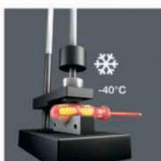
В экстремальных условиях применения безопасность также гарантируется благодаря проверенной ударопрочности при низких температурах -40 °C.
