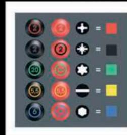
Отвёртки, снабжённые идентификаторами инструментов Take it easy: цветовая кодировка профиля наконечника и маркировка размера на ручке отвёртки
