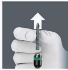
Для смены насадки необходимо просто сдвинуть втулку вперед; при этом пружинный механизм приподнимет биту с магнита и разблокирует инструмент. Бита легко извлекается.
