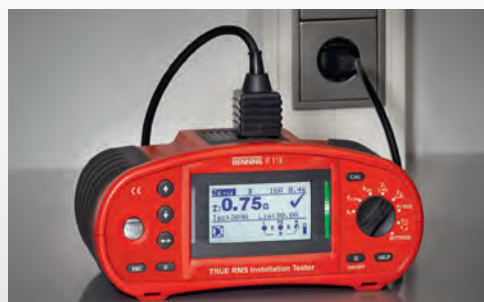
IT 115 bei der Schleifenimpedanzmessung ohne RCD-Auslösung
