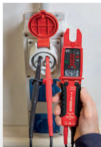
Spannungsmessung und Drehfeldrichtungsprüfung
