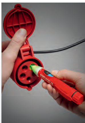
Drehfeldprüfung Grün = Rechtsdrehfeld
